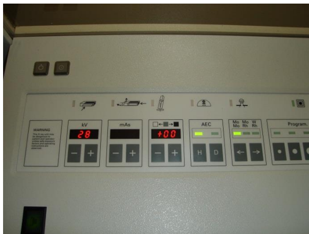
Figura 20: Seleção da técnica radiográfica
