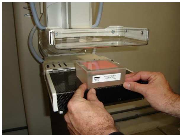
Figura 7: Posicionamento do simulador
