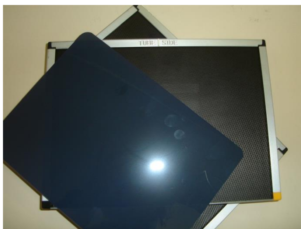
Figura 4: Chassis e filme radiográfico
