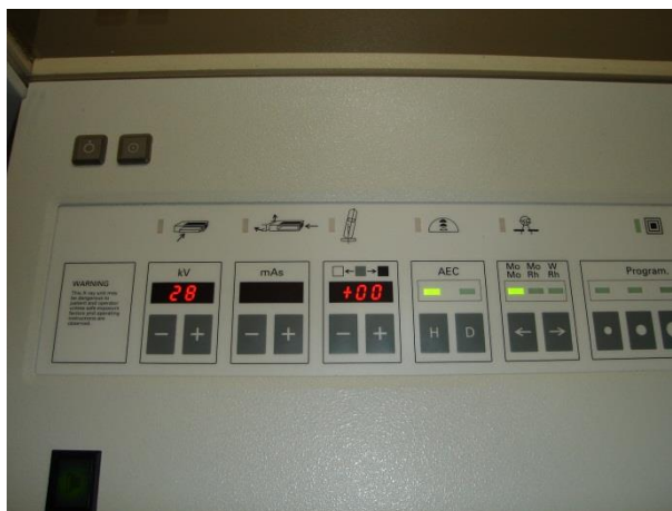
Figura 11: Seleção da técnica radiográfica
