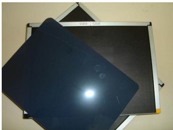
Figura 14: Chassis e filme radiográfico
